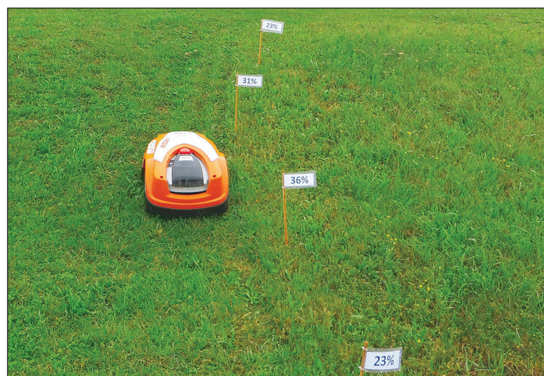
Bei Hanglagen wird es für einige Roboter schwierig, hier ist die Steigungsangabe der Anbieter mit Vorsicht zu genießen. Fotos: Stiftung Warentest
