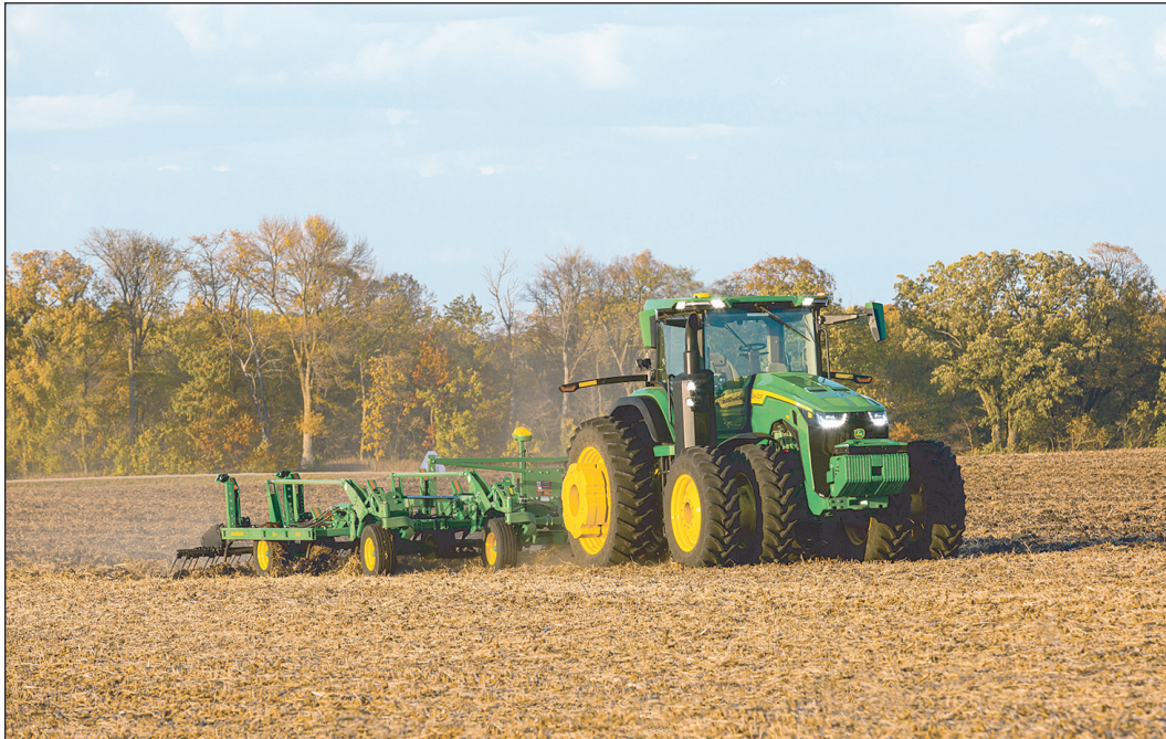
In diesem Frühjahr präsentierte John Deere den serienreifen vollautonomen Traktor 8R 410 mit einem firmeneigenen Grubber mit spezieller Tiefenführung und GPS-Leitsystem. Werkfotos
