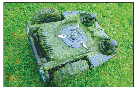
Geprüft wurden Geräte, die 450 - 800 m² Fläche mähen, im Bild ein Mähroboter von unten.
